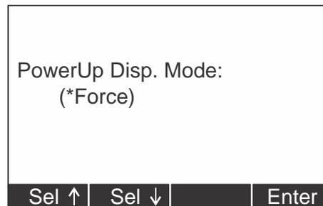
2. Para seleccionar el valor del modo de visualización, utilice las teclas **Sel** (Seleccionar) para desplazarse por las opciones. Las opciones son Force (Fuerza) (valor predeterminado), Peak (Pico), Dual (Doble) y Last (Último). Presione **Enter** (Introducir) para aceptar el ajuste que se muestra.
