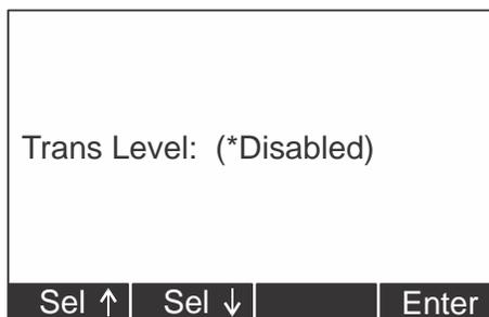
2. Seleccione un nivel de transmisión con las teclas **Sel** para activar como RS-232 o desactivar. Las opciones son: Disabled (Desactivado) (valor predeterminado), RS232. Presione **Enter** (Introducir) para aceptar el ajuste. Lea la nota de más abajo
