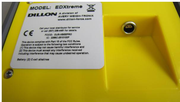
Figure 2.2 Connecteur EDXtreme (CELL)
