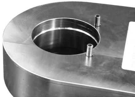
**Figure 7.3 Goupilles cylindriques sortant du haut du corps du dynamomètre**
