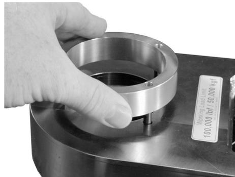
**Figure 7.4 Placement de la deuxième entretoise sur les goupilles cylindriques**
