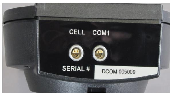
**Figure 2.4 Connecteurs CELL et COM1**
