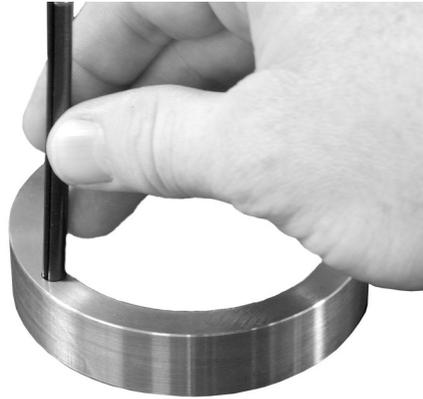
**Figure 7.2 Insertion de la goupille cylindrique**
