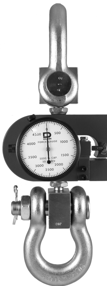
Figura 2.3 Modelo para fuerzas de tensión con adaptadores y grilletes
